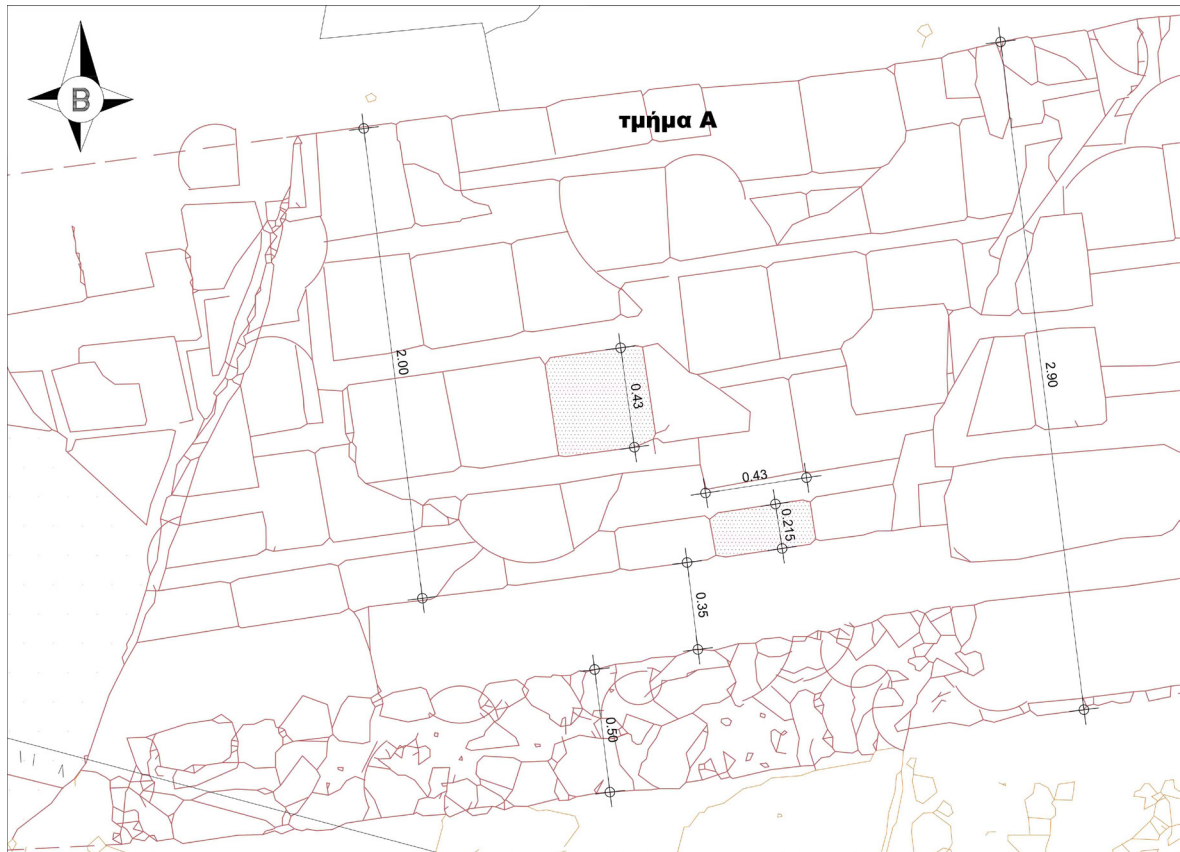
Εικ. 8. Θέση 1, τμήμα Α. Ο πλίνθινος κορμός στο θεμέλιο έχει πλάτος 2 μ. και απέχει 0,35–0,43μ. από το λίθινο μέτωπο.
